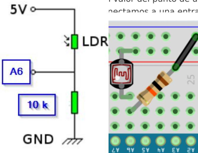
Una vez realizadas las conexiones, si midieramos la salida del sensor con un voltímetro nos daría un valor decimal, por ejemplo un nivel de luz “intermedio” (rango de 0 a 5V) de un sensor de luz podría dar 3,3 voltios. Este tipo de información el microcontrolador **no la entiende tal cual**, sólo
