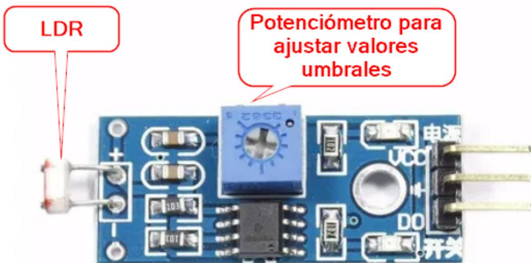
Estos módulos proporcionan 3 pines: dos que son la alimentación, (0V, GND o - ) y (+5V V+o Vcc) y el pin que proporciona la lectura (Vout o D0 o I/O). En el caso de que sea un sensor que mida una magnitud analógica como en este caso la luz, suelen proporcionar un potenciómetro para determinar qué luminosidad se considera un 0 o un 1.
