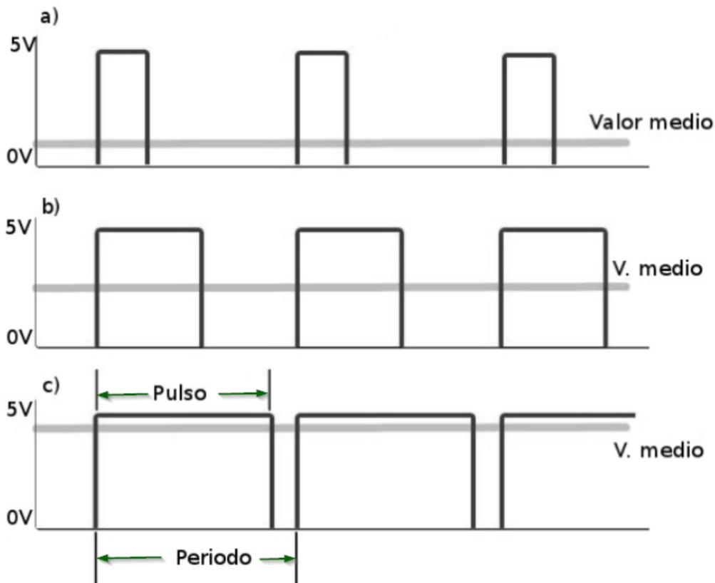
De esta manera podemos simular señales analógicas, esto es muy útil para activar servomotores y llevarlos a una posición determinada o variar la luminosidad de un led o en los motores de los robots que vayan más deprisa o más despacio
