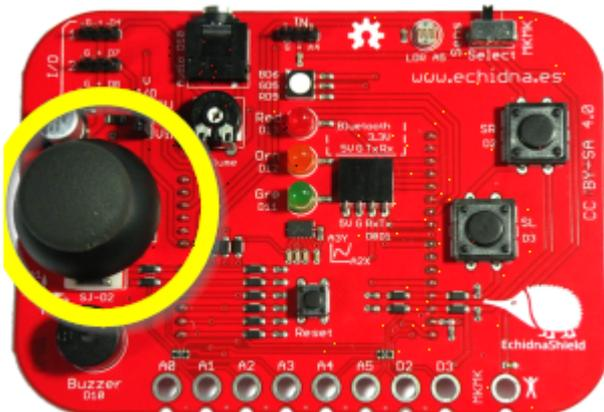
Este sensor es **analógico**, su salida puede ser cualquier valor entre Vcc y GND (si está en divisor de tensión como en la placa Edubásica no llega a esos valores extremos), por lo tanto hay que conectarlo a una entrada analógica de Arduino y como cualquier entrada analógica, proporcionará valores entre 0 y 1023.
