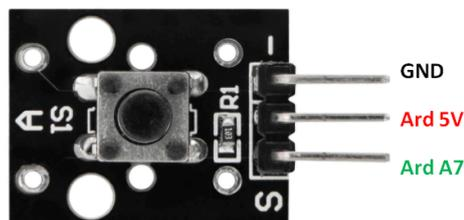
Otra manera más "barata" de sustituir este módulo pulsador es poner un pulsador normal y una resistencia ( $\pm 10k$ ), al pulsar se produce una entrada en el Arduino, hay dos configuraciones, que al pulsar se emita un 0 lógico (configuración **Pull up**) o que al pulsar emita un 1 lógico (configuración **Pull down**) ¿Por qué hay que poner una resistencia?
