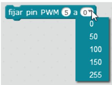
Donde 0 sería 0V y el valor 255 sería el valor máximo de tensión que en nuestro caso es 5V aunque puede ser otra tensión si se alimenta Arduino con una alimentación externa  $V_{in}$ .
