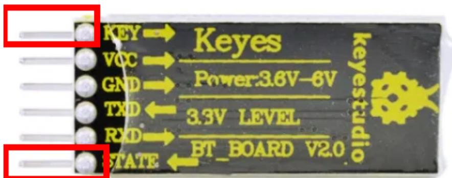
El **HC-05** puede funcionar como maestro y esclavo. La diferencia con el módulo **HC-06** que sólo funciona como esclavo. El **HC-05** es por lo tanto un módulo técnicamente superior. Físicamente el **HC-05** tiene 6 pines mientras que el **HC-06** sólo 4. Esto le permite al **HC-05** trabajar con distintos modos de funcionamiento más avanzados, (ver <https://fgco.ca.github.io/Bluetooth-HC-05-y-HC-06/modulos/>)
