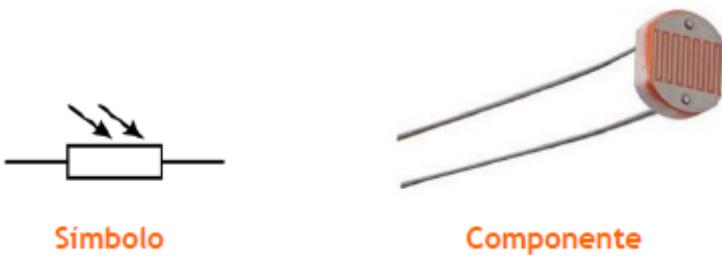
En la placa Imagine TDR STEAM la fotoresistencia está denominada como "Light AI" y viene conectada
