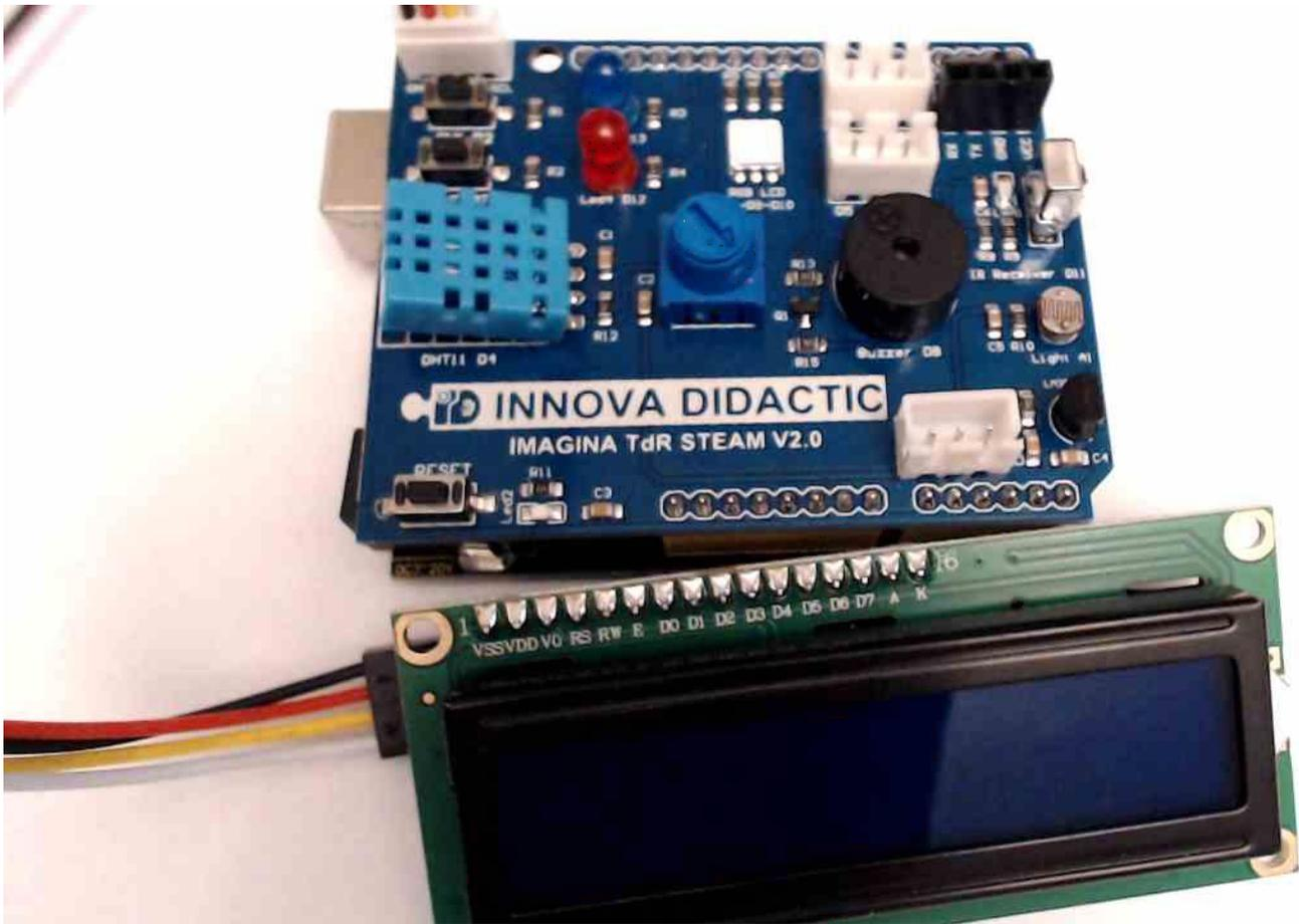
En la configuración de la pantalla hemos de seleccionar la dirección de configuración 0x27.
