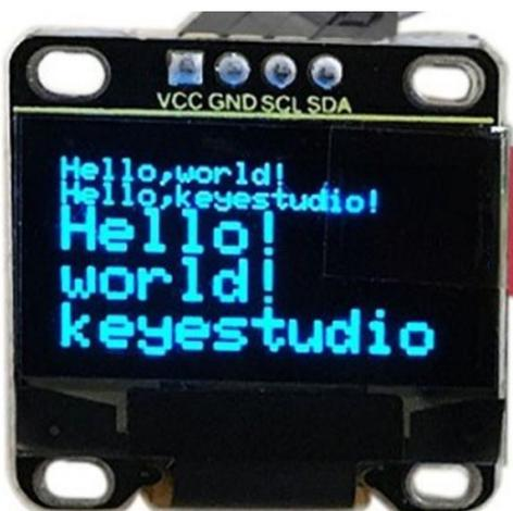
La pantalla que vamos a utilizar es una pantalla OLED de 0,96 pulgadas de 128x64 pixeles. OLED es la abreviatura de diodo emisor de luz orgánico. En el nivel microscópico, una pantalla OLED es una matriz de leds que se iluminan cuando emiten energía. La tecnología antigua de las LCD (pantalla de cristal líquido) utiliza polarizadores controlados electrónicamente para cambiar la forma en que la luz pasa o no pasa a través de ellos. Esto requiere una luz de fondo externa que
