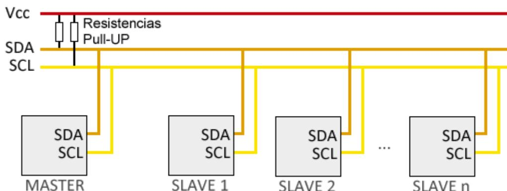
En el bus, cada dispositivo dispone de una dirección, que se emplea para acceder a los dispositivos de forma individual. Esta dirección puede ser fijada por hardware (en cuyo caso, frecuentemente, se pueden modificar los últimos 3 bits mediante “jumpers” o interruptores, o por software.
