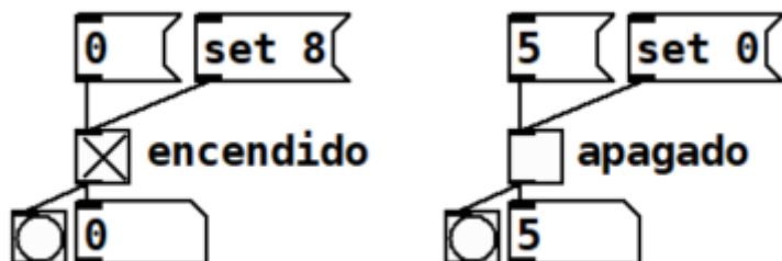
Figura 15. patch Toggle.pd . Mensaje "set" para cambiar el estado del toggle sin que emita ningún valor.
