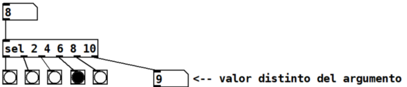
Figura 11. patch select-demo.pd . Objeto select con 5 argumentos.
