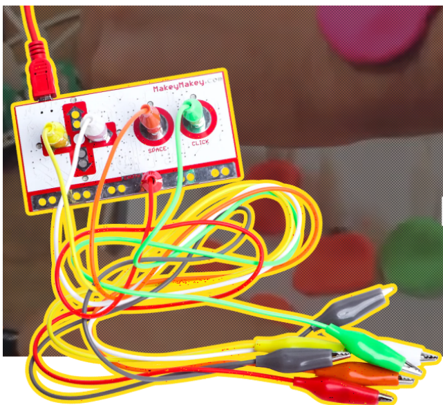
Placa con cable USB y cables alligator (cocodrilo)
