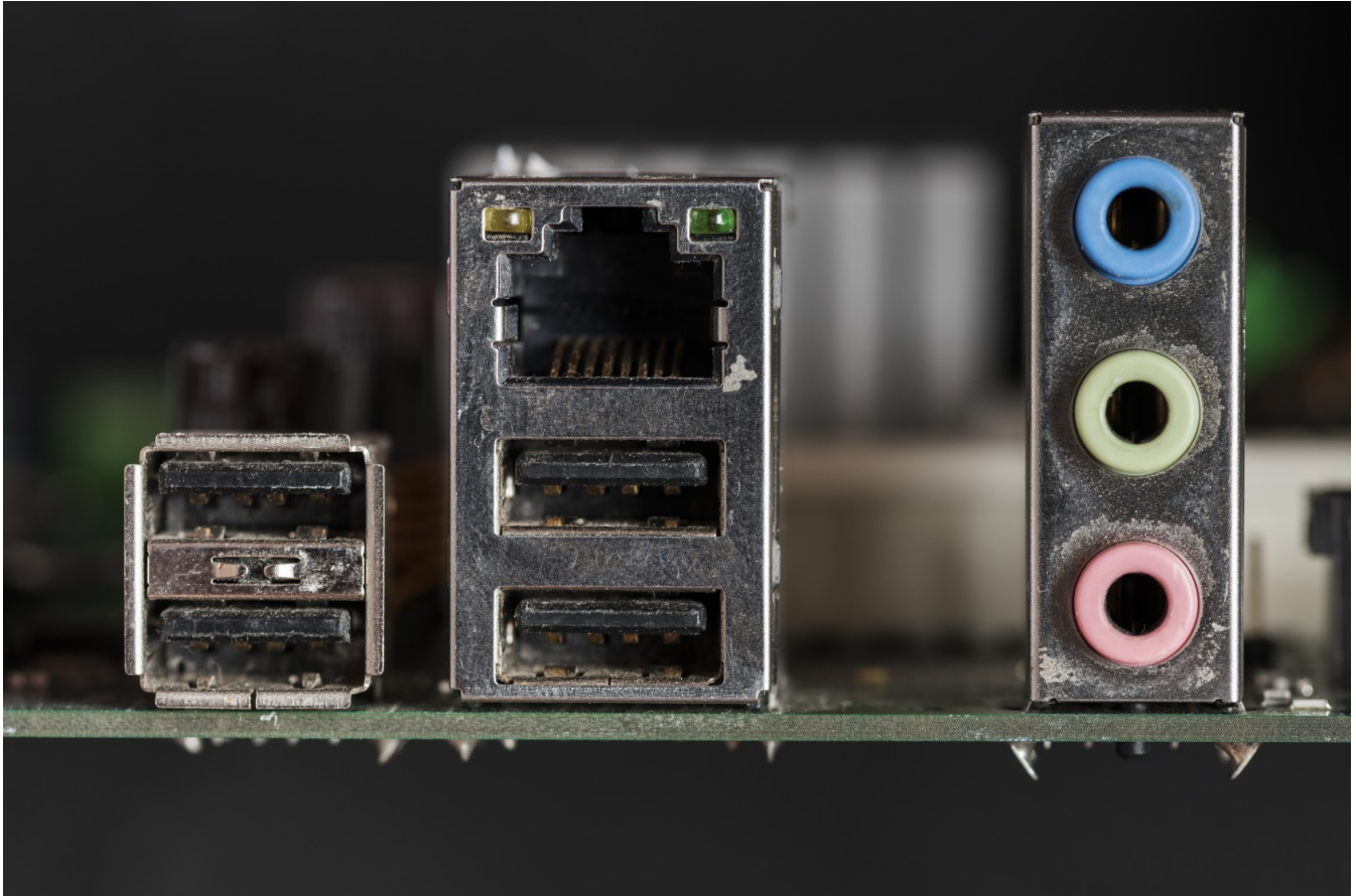
Freepik . Puertos de conexión USB, de sonido y ethernet. ( CC BY-SA )
