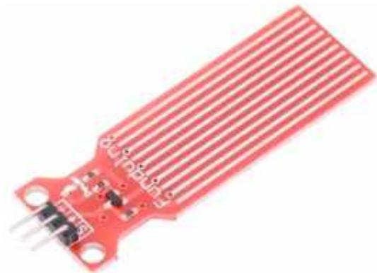
Es un sensor muy sencillo: Al mojar los conductores, aumenta la conductibilidad y se traduce en una salida HIGH en su pin de salida **S**.
