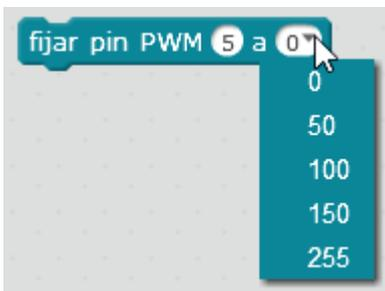
Donde 0 sería 0V y el valor 255 sería el valor máximo de tensión que en nuestro caso es 5V aunque puede ser otra tensión si se alimenta Arduino con una alimentación externa Vin.
