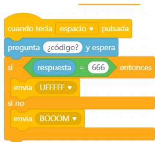
**El script que desactiva la alarma** es cuando reciba el mensaje `_Ufff_` por lo tanto para el cronómetro y apaga el laser:
