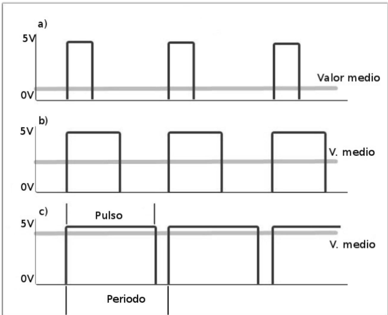
Los pines digitales de la placa Arduino que se utilizan como salida de señal PWM generan una señal cuadrada de frecuencia constante (490Hz), sobre esta señal periódica por programación podemos variar la duración del pulso como vemos en estos 3 casos:
