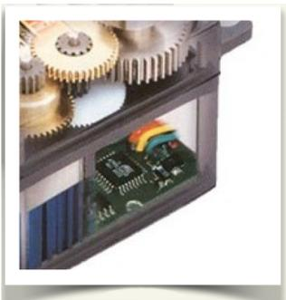
Los servos son un tipo especial de motor en el que se añade un circuito lógico electrónico que permite un control mucho más preciso que a un motor normal de corriente continua. Esto les permite posicionar el eje en un ángulo determinado.
