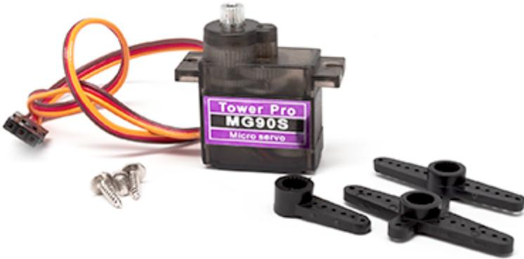
Este servo se controla con una salida digital, y se les indica el ángulo de giro, que puede ir desde 0º hasta 180º (no permite otro margen). Si elegimos otro más barato, puede tener deriva en los extremos ([ver vídeo con HD-144A](#))
