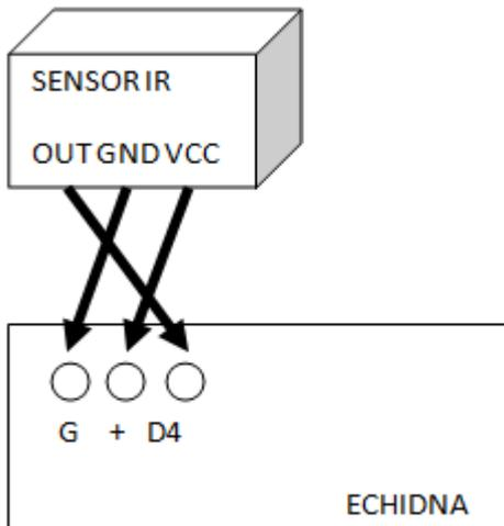
Nota: Hay sensores con 4 pines, que permiten alimentar el diodo IR de forma independiente, pero tienen un jumper que inutiliza el 4 para sólo utilizar los 3 pines.
