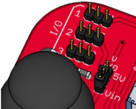
Hay muchos módulos para conectar, y todos tienen la misma configuración en sus pines : GND, + , I/O, donde I/O es el pin digital o analógico de entrada o salida, dependiendo del sensor, y como puedes ver en la figura, hay mucha variedad (busca en Internet sensores para Arduino)
