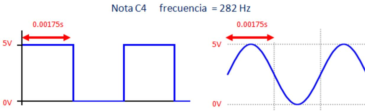
No es lo mismo una onda analógica sinusoidal de 282 Hz que una onda digital cuadrada que es lo que se reproduce en la salida digital D10
