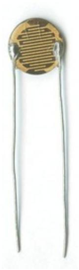
“ Fotorresistor *Una fotorresistencia es un componente electrónico cuya resistencia disminuye con el aumento de intensidad de luz incidente. Puede también ser llamado fotorresistor, fotoconductor, célula fotoeléctrica o resistor dependiente de la luz, cuyas siglas, LDR, se originan de su nombre en inglés light-dependent resistor. Su cuerpo está formado por una célula fotorreceptora y dos patillas.* <sup>W</sup>
