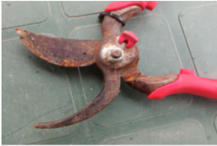
Tijeras de podar oxidadas por almacenamiento incorrecto
