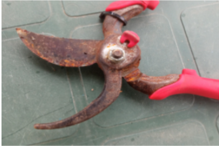
Tijeras de podar oxidadas por almacenamiento incorrecto
