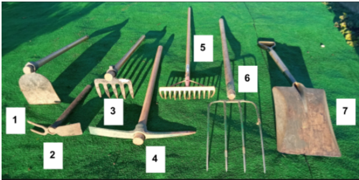
1: azada; 2: azadilla de dos púas; 3: rastrillo de cuatro púas; 4: pico; 5: rastrillo; 6: horca; 7: pala de punta cuadrada
