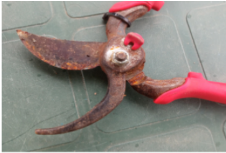
Tijeras de podar oxidadas por almacenamiento incorrecto
