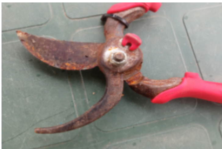
Tijeras de podar oxidadas por almacenamiento incorrecto
