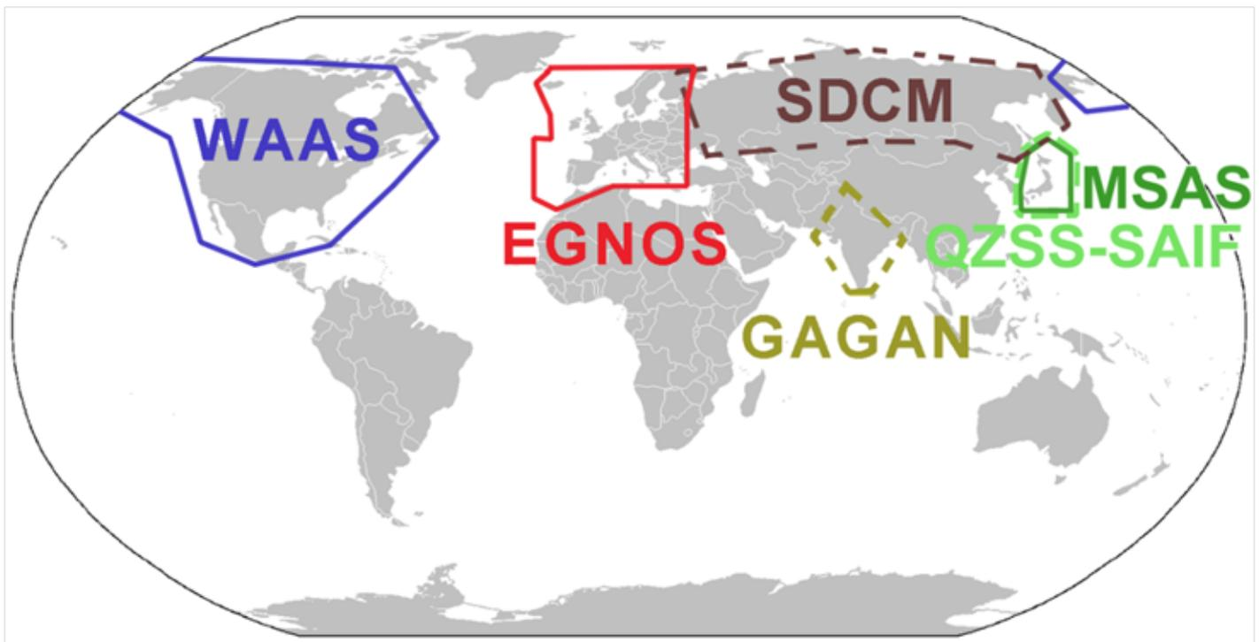
Los **sistemas SBAS** (Satellite Based Augmentation System o Sistema de Aumentación Basado en Satélites), **es un sistema de corrección de las señales que proporcionan los Sistemas Globales de Navegación por Satélite GNSS** (GNSS=GPS+GLONASS+Galileo).
