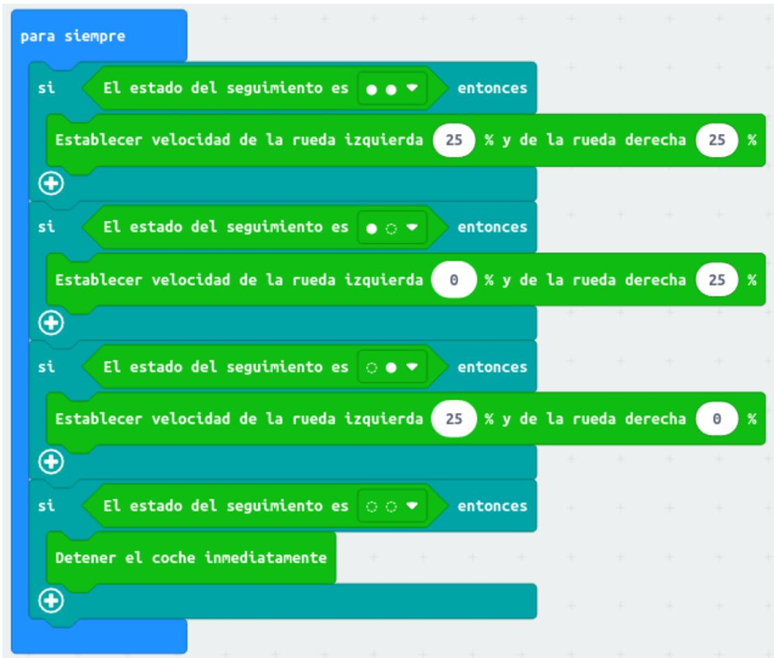
Quando las pilas estén muy frescas, Cutebot se desplazará más rápido y puede que pierda la línea continuamente. Este problema se soluciona reduciendo la velocidad de las ruedas, por ejemplo al 20%.
