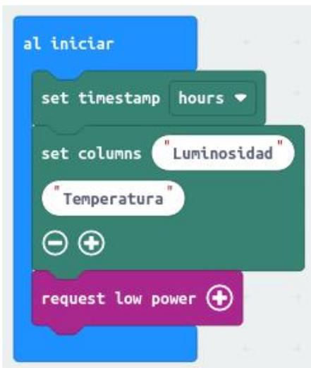
Por supuesto, es posible ahorrar energía eliminando el piloto **LED** intermitente, pero vamos a mantenerlo en funcionamiento. El evento de piloto estará ahora controlado por **full power every 1000 ms**. Es decir, despertaremos a micro:bit cada segundo para invertir el estado del piloto **LED**.
