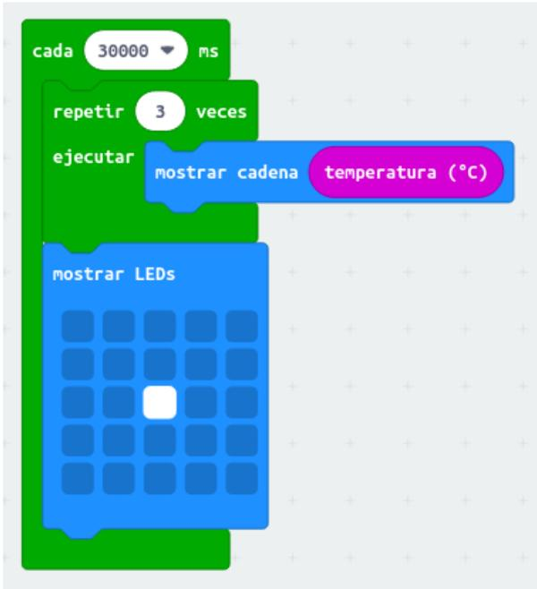
Nótese que el programa ejecuta un bucle cada 30 segundos, y que dentro de ese bucle se ejecuta otro bucle que muestra la temperatura tres veces seguidas. Al hecho de introducir un bucle dentro de otro se le llama **anidar bucles**.
