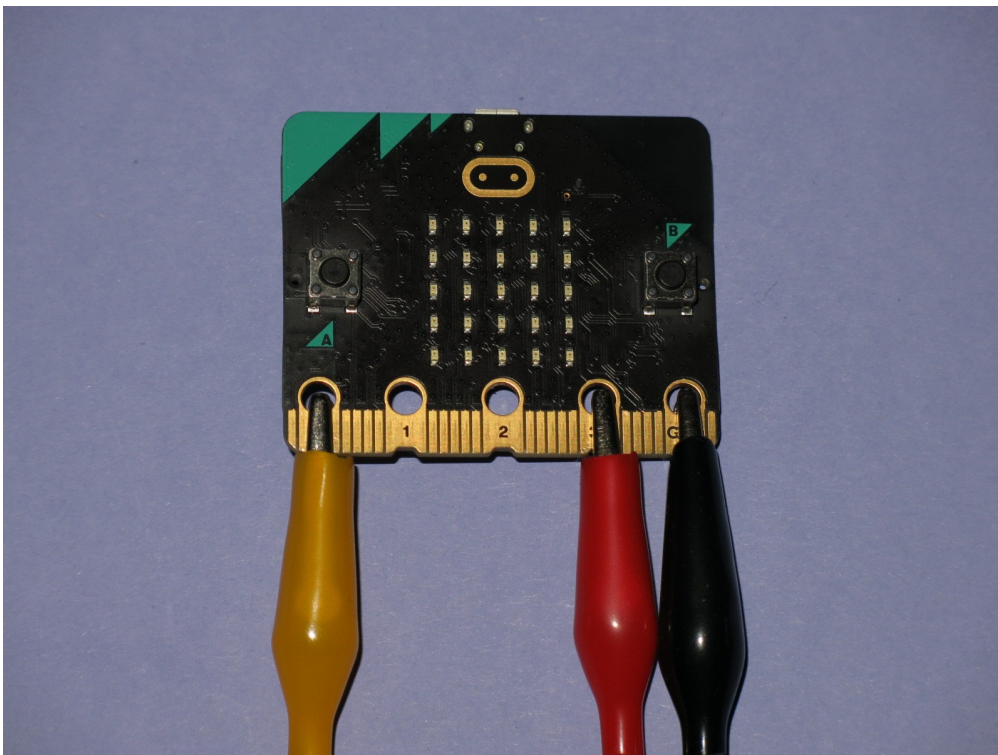
Pinzas de cocodrilo conectadas a micro:bit V2. Elaboración propia
