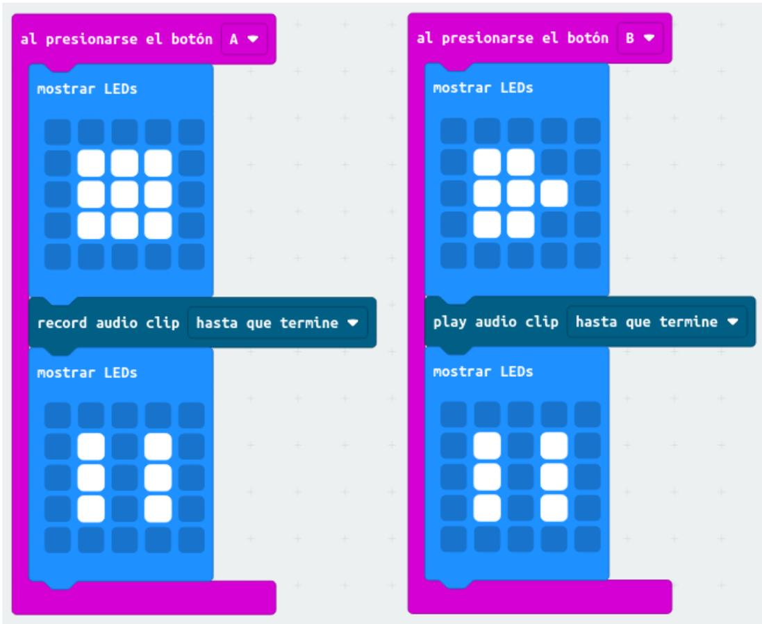
Una vez introducido el código, el simulador de MakeCode nos ofrecerá la posibilidad de probar el funcionamiento del programa sin necesidad de descargarlo previamente en la placa. Para ello usará el micrófono y el altavoz de nuestro ordenador.
