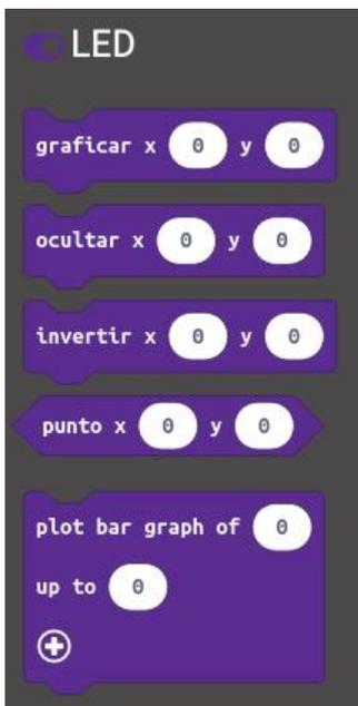
**Graficar** enciende el LED de coordenadas x e y. La coordenada 0, 0 corresponde al LED situado en la esquina superior izquierda de la pantalla, mientras que la coordenada 4, 4 es la del LED de la esquina inferior derecha. El LED central es el de coordenadas 2, 2.
