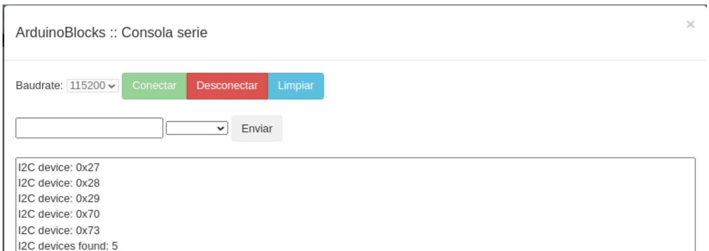
Consola para el programa Escaner-I2C en el bucle con 5 dispositivos Imagen Federico Coca Notas sobre ESP32 STEAMakers CC-BY-SA
