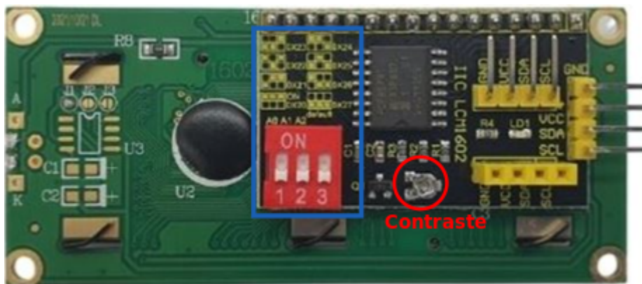
Configuración dirección física en la parte posterior LCD I2C con microinterruptores
