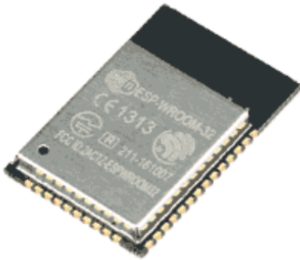
Módulo ESP32 Fuente Luis Llamas CC-BY-NC-SA https://www.luisllamas.es/esp32/
