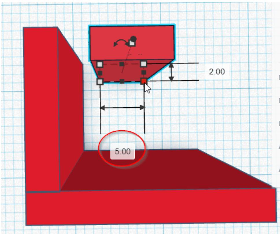
(Da igual copiar un trozo ya hecho que crear otro nuevo, la ventaja de copiar un trozo de los ya diseñados es que ya tenemos el grosor de 2mm y la altura de 20 mm)
