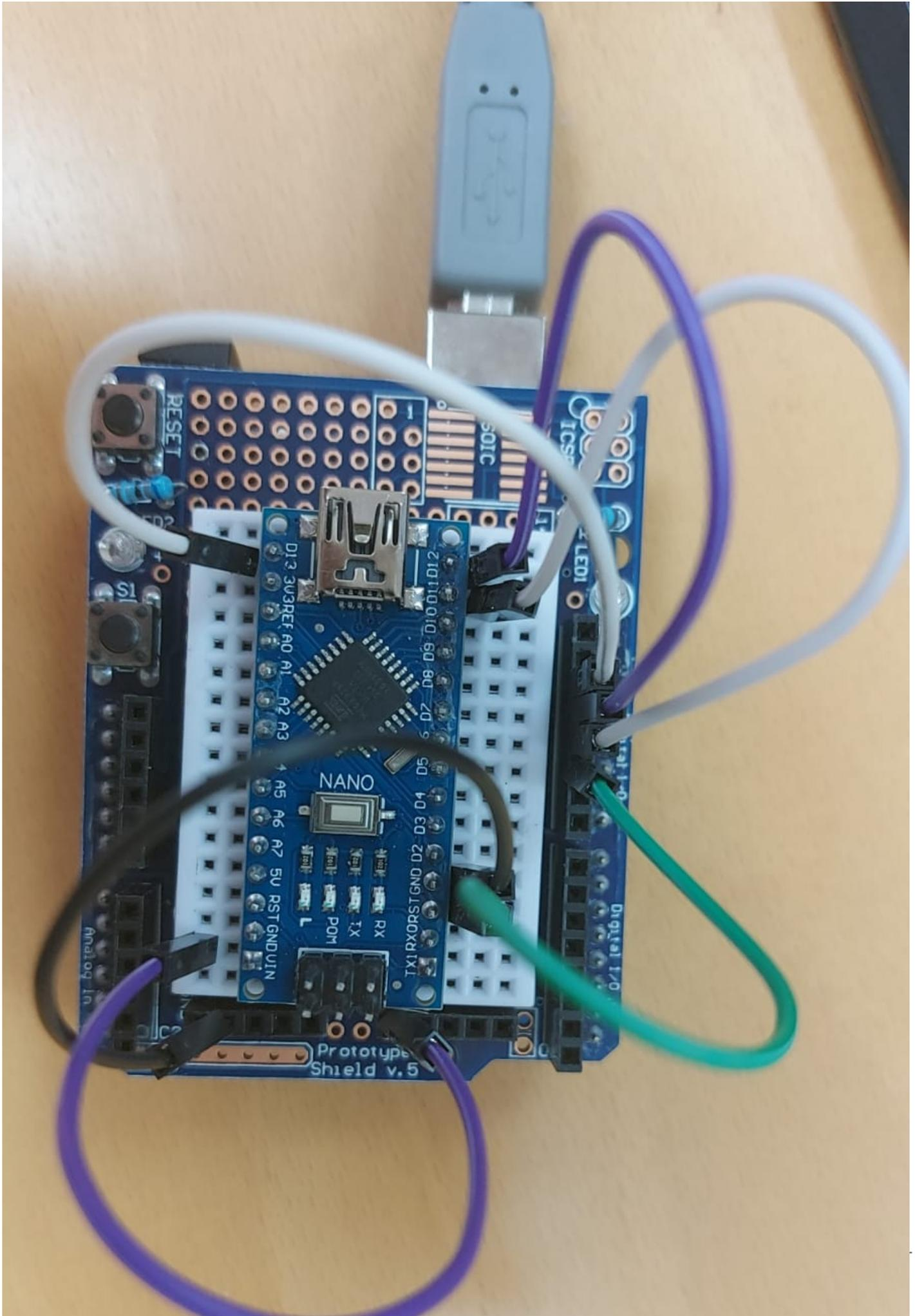
Paso 1: Grabar en el Arduino el programador ArduinoISP de ejemplos
