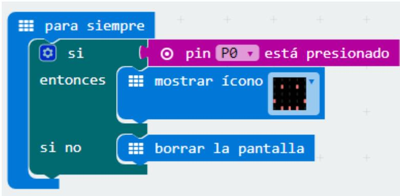
Para comprobar el funcionamiento se puede usar un cable con bananas conectados al GND, si se conecta con el P0 y el cable tiene continuidad, deberá aparecer una carita feliz en el panel LED.
