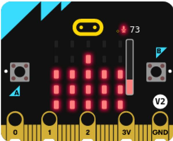
Tras descargar el programa en la placa real, la matriz de LED representará continuamente el sonido recogido por el micrófono en forma de barra vertical. El **LED del micrófono** iluminado indicará que micro:bit está captando sonido.
