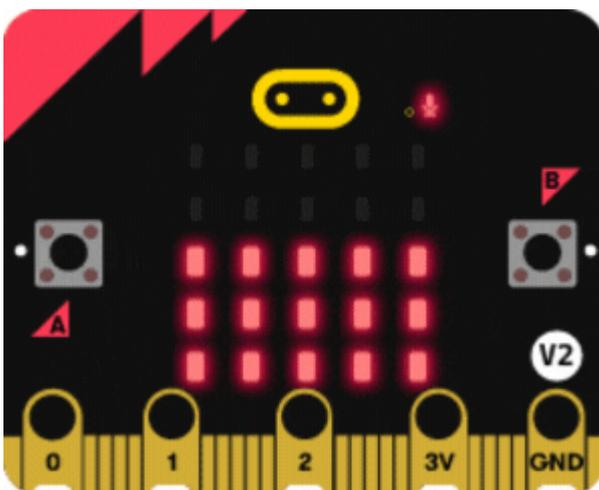
Una tarjeta micro:bit ejecutando este programa puede agotar un par de pilas alcalinas IEC R03 (AAA) en unas 40 horas (Frost 2018). Para **ahorrar energía** y prolongar la autonomía del medidor podemos reducir tanto el **brillo de la pantalla** como el **número de medidas por segundo** que
