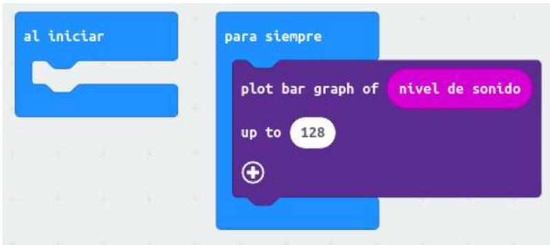
La variable **nivel de sonido** debe arrastrarse desde el menú **Entrada**. En el momento en el que la variable haya sido introducida en el programa, el simulador de micro:bit cambiará, mostrando una **barra ajustable** que simulará el nivel de sonido captado por el micrófono. El valor numérico del nivel de sonido simulado también será mostrado al lado del **LED** del micrófono.
