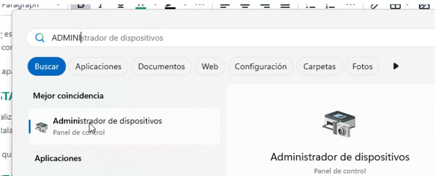
Al ejecutarlo vemos que aparece un dispositivo nuevo conectado en los puertos COM (si tienes dudas, conecta y desconecta la microbit) en la imagen aparece el COM19
