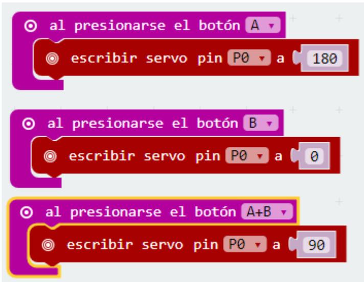
En el simulador aparece la imagen de un servo y hará lo programado según el pulsador accionado.
