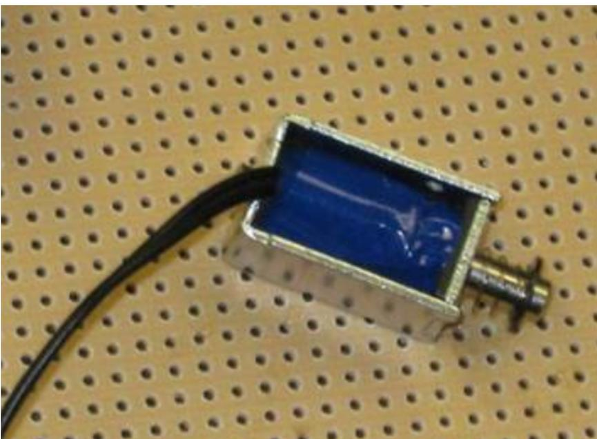
Un solenoide se encarga de convertir un campo electromagnético, que genera él mismo gracias a una bobina de hilo conductor, en energía mecánica. En el caso de la imagen superior, lo que hace este tipo de solenoide es mover hacia afuera el pequeño tubo metálico que vemos en la parte derecha de la imagen. Esto produce un pequeño golpe, por lo que una de las aplicaciones típicas de estos solenoides es para generar diferentes sonidos.
