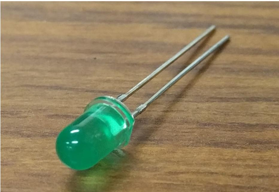
Este componente es uno de los primeros que se utilizan con Arduino, ya que es una manera rápida de obtener una verificación sobre el funcionamiento de nuestro código. Por ejemplo, con nuestro código podemos decir: "Si la medición de *un sensor* está entre *este* y *aquel* valor, enciende el LED; de lo contrario, no hagas nada."
