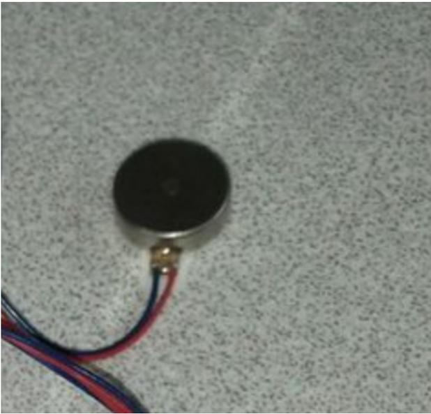
El motor de vibración es un motor de corriente continua de tamaño compacto que nos informa de una variación, detectada por el sensor correspondiente, mediante su **vibración**. Este sensor **no tiene sonido** y principalmente se utiliza en los teléfonos móviles, joysticks, o cualquier proyecto que requiera de una señal táctil.
