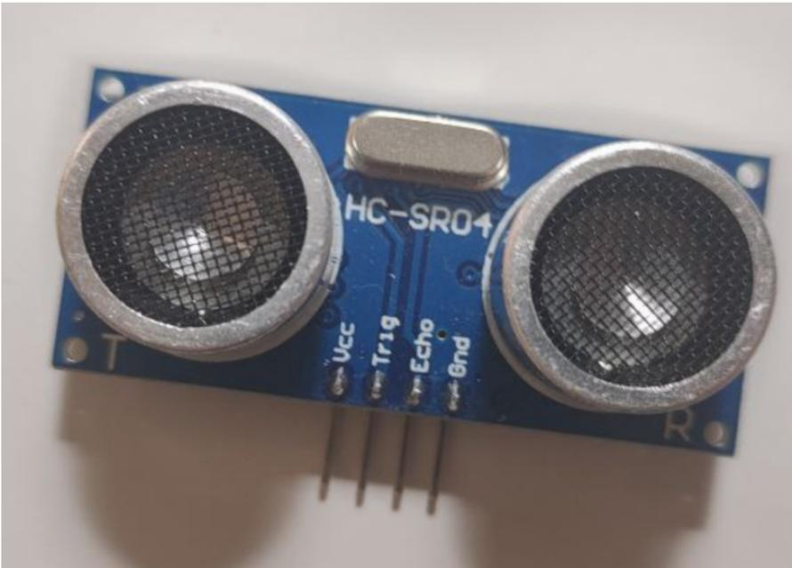
Este sensor nos permite conocer la distancia a la que se encuentra un determinado objeto. Una explicación detallada sobre este sensor, junto con un ejemplo del código sobre su funcionamiento, la encontramos en este video:
