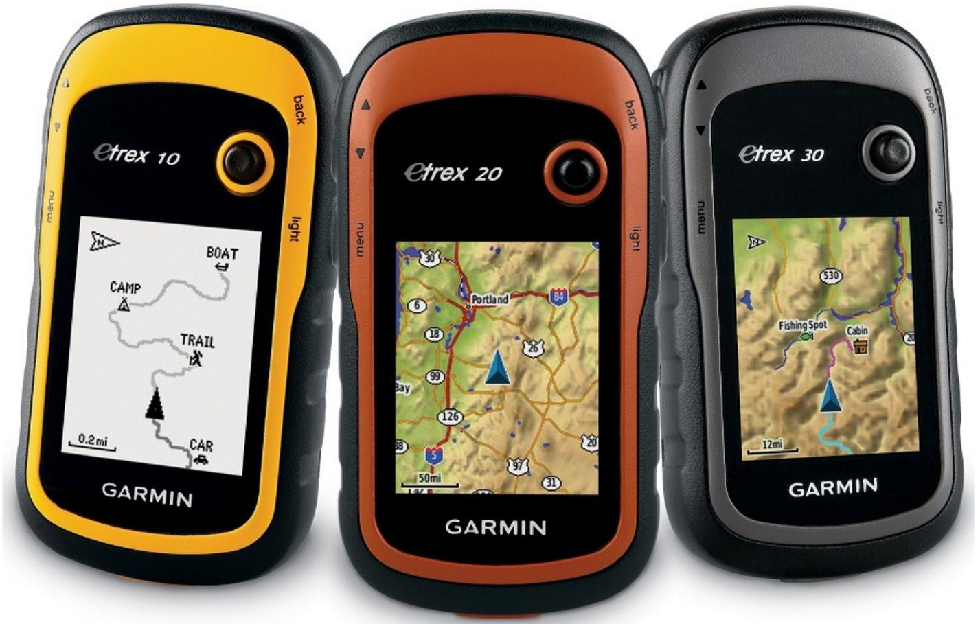
Un **GPS** es un aparato que permite obtener las coordenadas de la geoposición del lugar donde se está en unos minutos y con una precisión de pocos metros.
