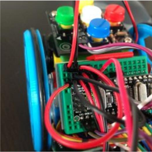
Usaremos otros dos cables macho-hembra para conectar las patillas RX, TX del Bluetooth con las del Arduino NANO.
