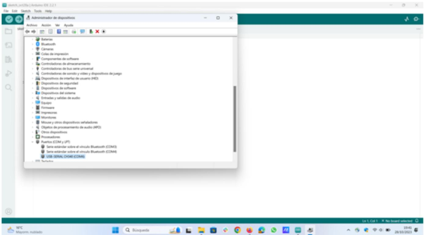
Ir a puertos(COM yLPT), ir al usb-serial 3h340(COMx) y desinstalarlo(botón derecho->desinstalar).
