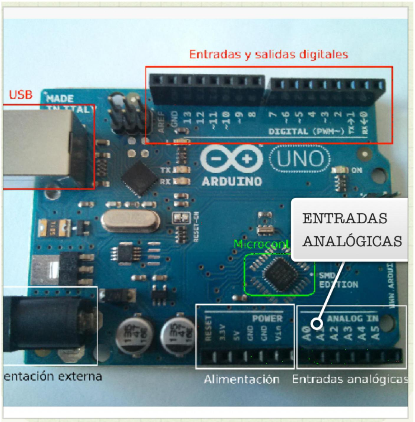
La placa de Arduino tiene 6 entradas analógicas marcados como "A0", "A1", ..., "A5" que reciben los valores continuos en un rango de 0V a 5V, pero la placa Arduino trabaja sólo con valores digitales, por lo que es necesario una conversión del valor analógico leído a un valor digital. La conversión la realiza un circuito analógico/digital incorporado en la propia placa.
