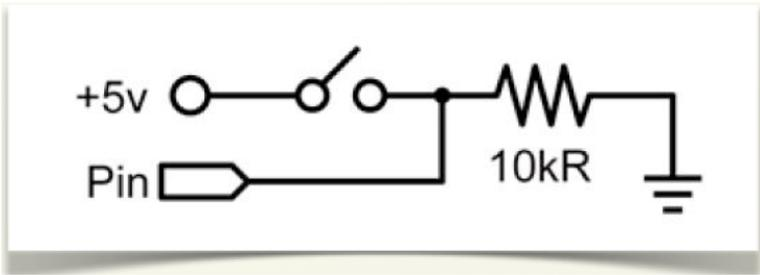
El funcionamiento de este circuito que está conectado al pin digital D2 como entrada es detectar si el pulsador está pulsado o no.
