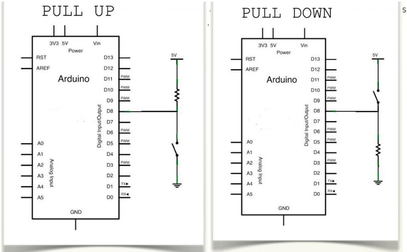
La resistencia **“pull-up”** establece un nivel alto (1) en la entrada digital en el estado de reposo del circuito. Un circuito con una entrada “pull-up” sería el siguiente.
