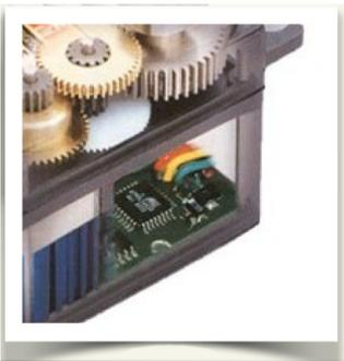
Los servos son un tipo especial de motor en el que se añade una circuito lógico electrónico que permite un control mucho más preciso que a un motor normal de corriente continua. Esto les permite posicionar el eje en un ángulo determinado.
