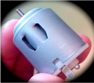
**Arduino (UNO)** no proporciona corriente suficiente para hacer funcionar, en condiciones "dignas", un motor de corriente continua de los que solemos usar en el aula-taller de Tecnologías (motor DC). Conviene alimentar Arduino con una fuente externa (7 -12 V) para poder proporcionar intensidad necesaria para el par motor requerido en los proyectos.
