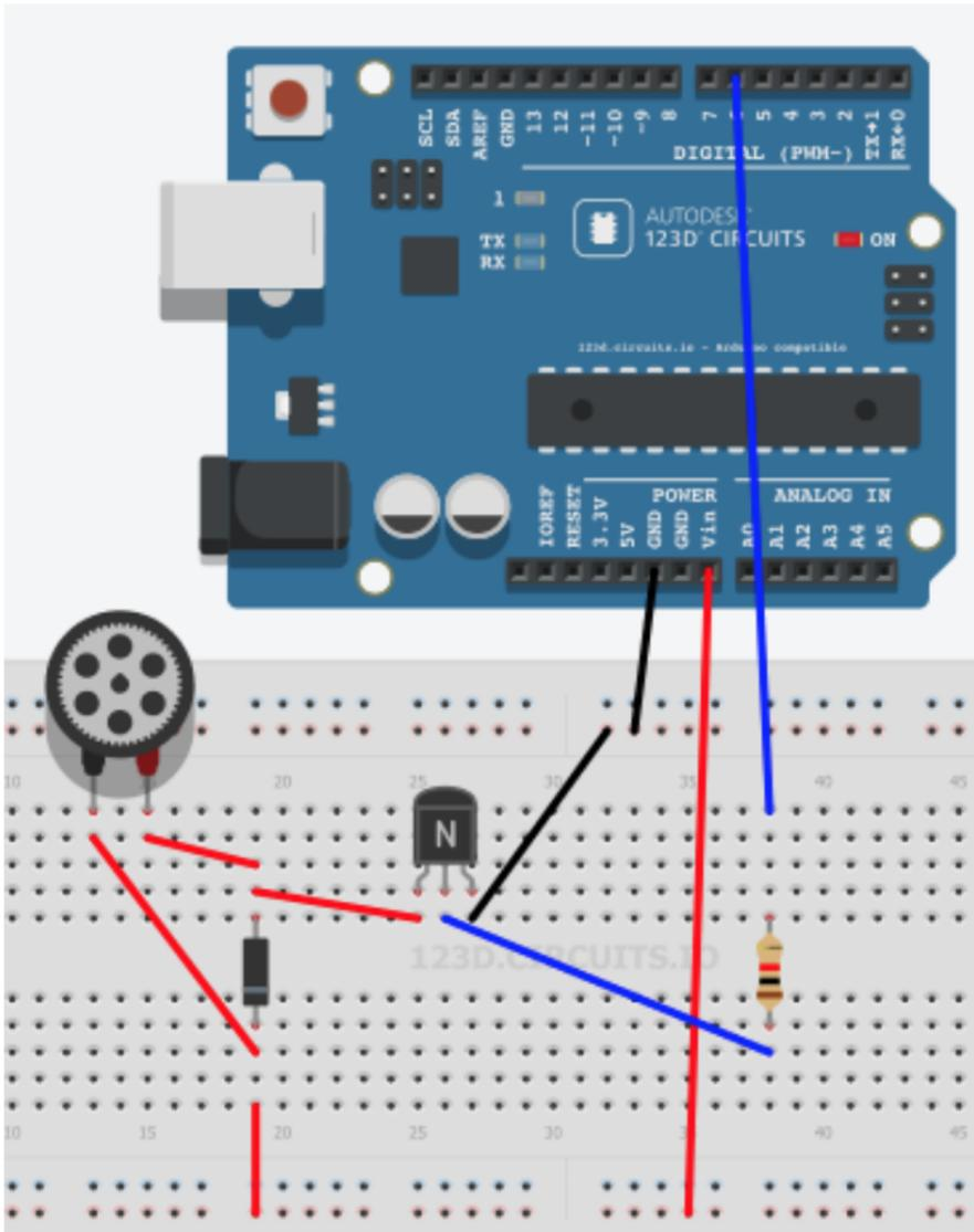
Importante: NO CONECTES EL MOTOR DIRÉCTAMENTE AL ARDUINO, PODRÍAS DAÑARLO
