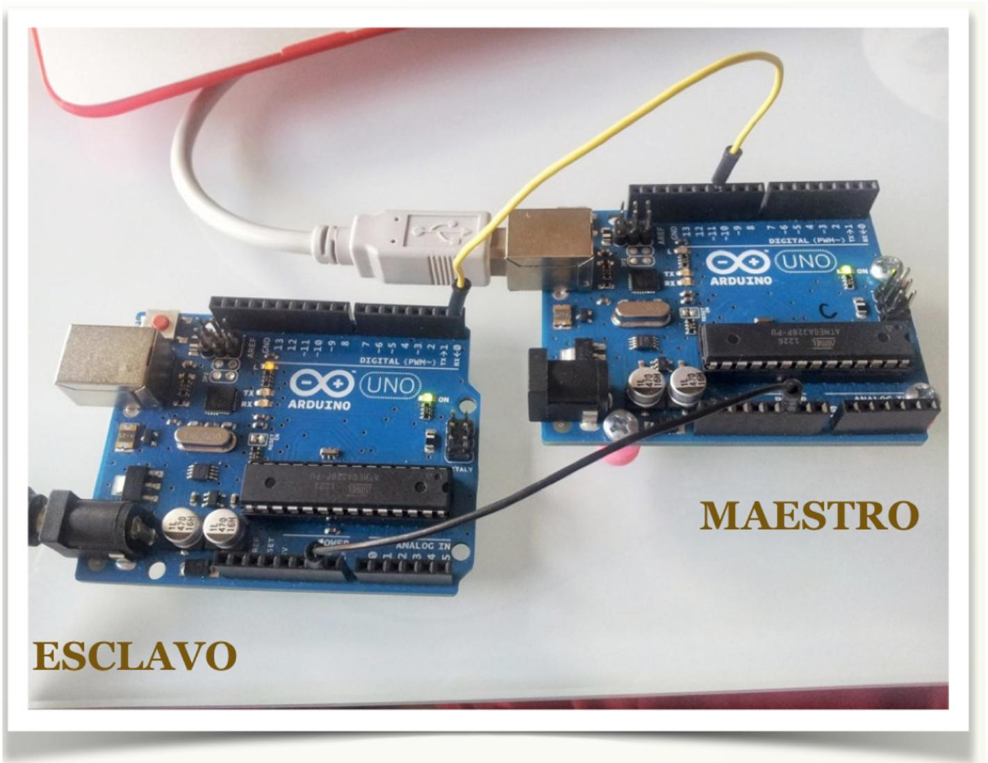
Podemos conectar dos placas Arduino de distintas maneras: Bluetooth, Xbee, Ethernet, WIFI... Pero la forma más sencilla es aprovechar la conexión para la comunicación serie que ya posee Arduino.
