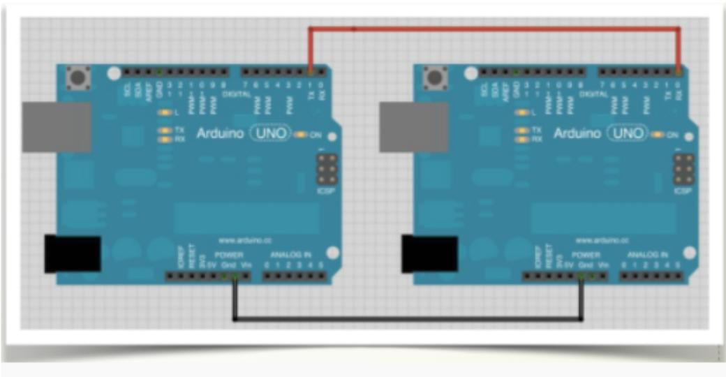
*maestro(izquierda) -> esclavo(derecha)* sólo necesitamos 1 conexión:
