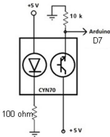
Su funcionamiento es sencillo, si el receptor recibe la señal del emisor, el transistor conduce, por lo que recibiremos un '1' lógico en el Arduino:
