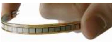
Para utilizar esta resistencia haremos un **DIVISOR DE TENSIÓN** que consistirá en poner dos resistencias en serie y repartirá la tensión total entre 0V y 5V en las dos resistencias, **el punto medio** será un punto que tendrá una tensión variable en función de las dos resistencias, como la es variable, esa tensión es variable y ya tenemos la entrada **analógica**:
