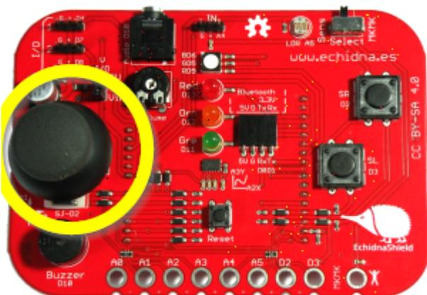
Este sensor es **analógico**, su salida puede ser cualquier valor entre Vcc y GND (si está en divisor de tensión como en la placa Edubásica no llega a esos valores extremos), por lo tanto hay que conectarlo a una entrada analógica de Arduino y como cualquier entrada analógica, proporcionará valores entre 0 y 1023.
