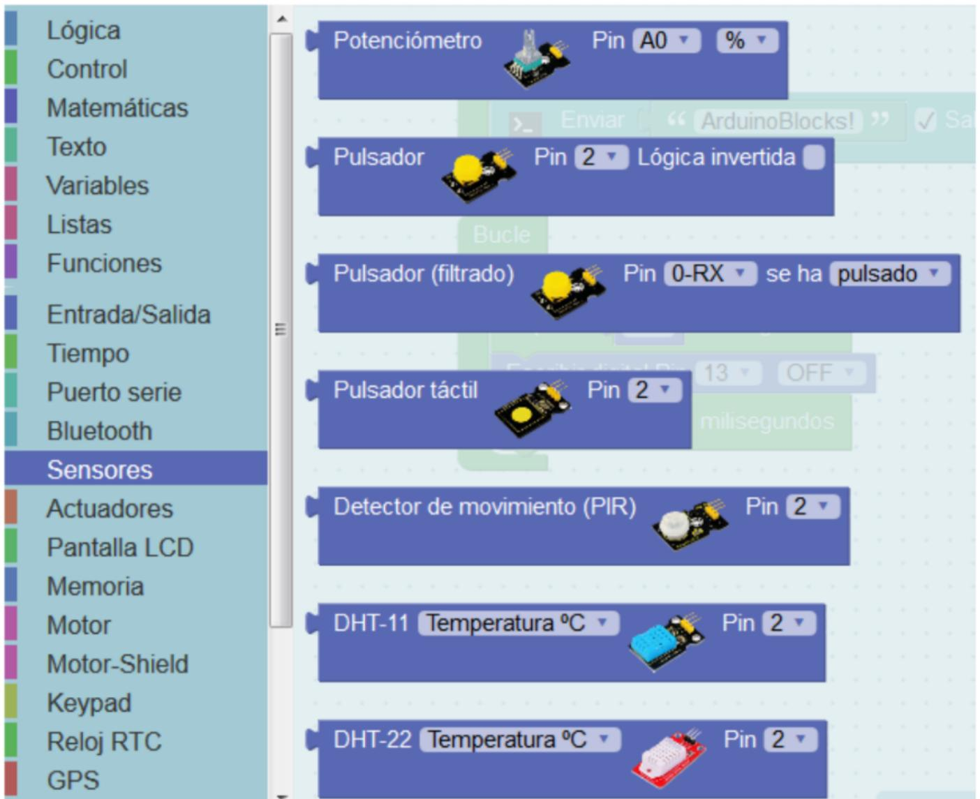
Un sensor es un objeto capaz de detectar magnitudes físicas o químicas y transformarlas en variables eléctricas. Los sensores o periféricos de entrada nos permiten obtener información del mundo real para utilizarla desde el programa de Arduino.
