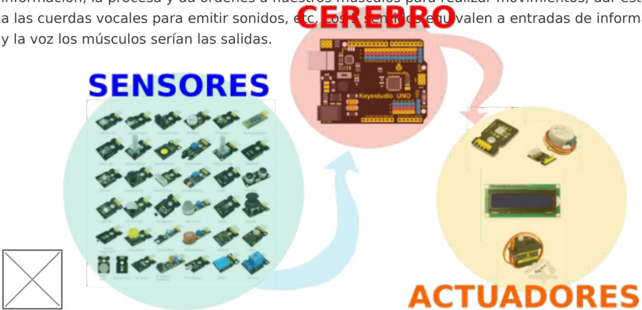
En el caso de un sistema de control programado, un microcontrolador hace la función de cerebro. Este componente electrónico unas entradas de información donde se conectan los sensores de luz (LDR), temperatura (NTC), sonido... y también tiene salidas, donde se conectan los motores, leds, zumbadores, etc.
