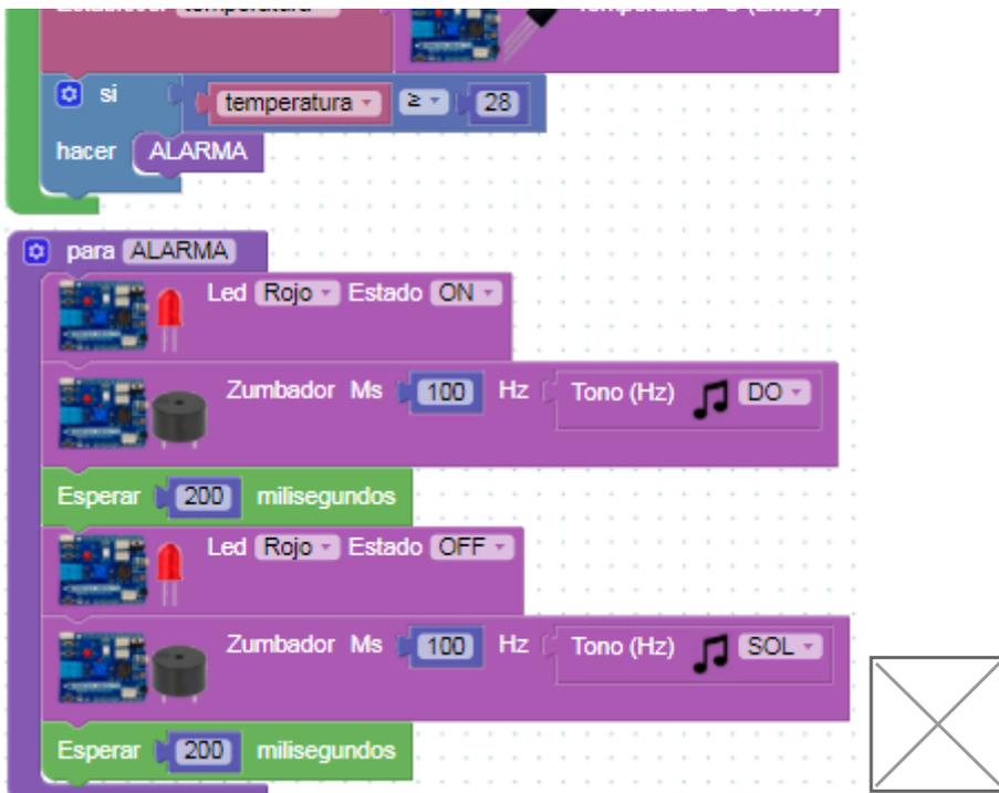
Actividad de ampliación: haz un programa que varíe el programa anterior para que encienda de color verde el led RGB si la temperatura inferior a los 28°C y rojo si la temperatura es superior a los 35°C. En el rango intermedio se indicará de color azul.
